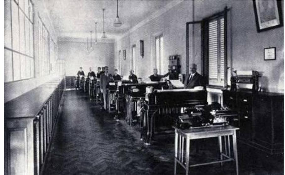
Gli impianti meccanografici delle Ferrovie dello Stato installati al Servizio Materiali e Trazione di Firenze e al Controllo Merci di Torino.
